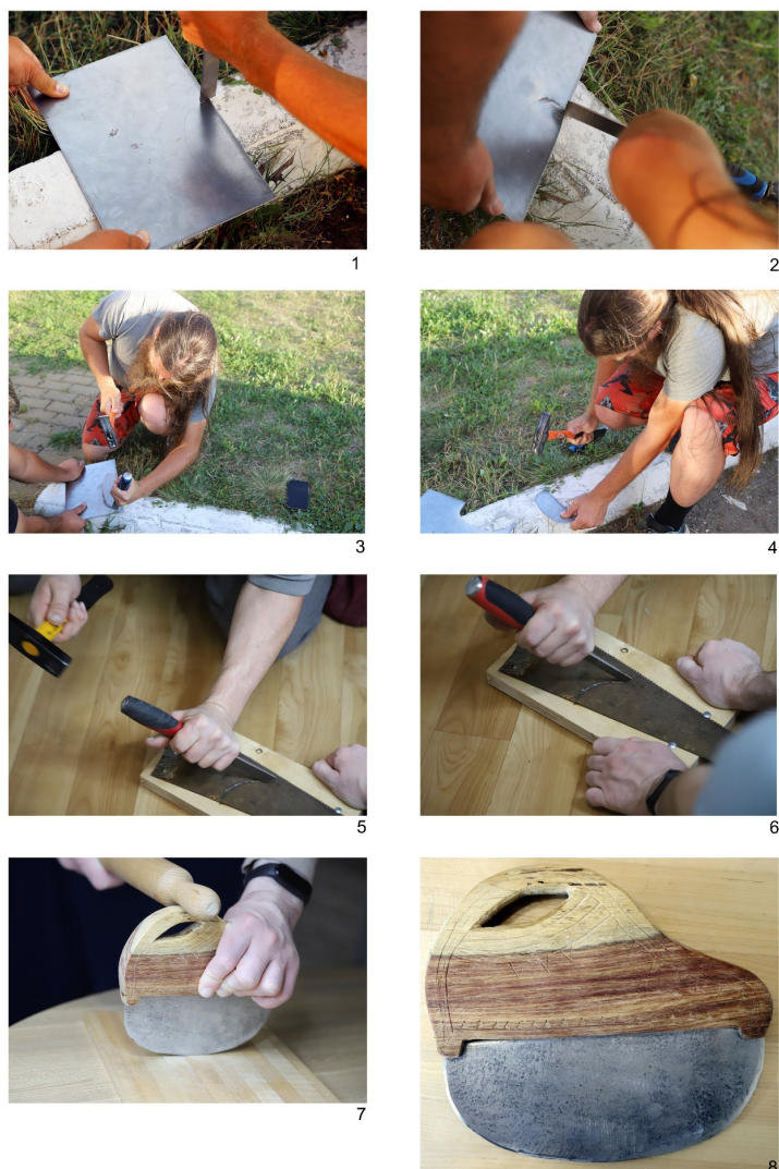
Рис. 6. Основные этапы изготовления реплики ножа-улу (улучик) из этнографической коллекции И.Г. Вознесенского эскимосов алутиик с о. Кадьяк (МАЭ № 593-44): 1–4 — из незакаленной стали; 5–8 — из закаленной стали: 1 — начало выбивки ножа стамеской под 90° к обрабатываемой поверхности; 2, 3, 5, 6 — выбивка ножа стамеской под 30° к обрабатываемой поверхности; 4 — выравнивание полотна ножа молотком; 7 — насаживание рукояти на нож с помощью деревянной колотушки; 8 — реплика ножа-улу, полученная в ходе эксперимента.
