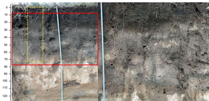
Рис. 6. Строение почвенного профиля отложений зольника Черноречье 2 и увеличенный участок золистого слоя — красная рамка; желтая пунктирная рамка — место отбора монолита для анализов.
