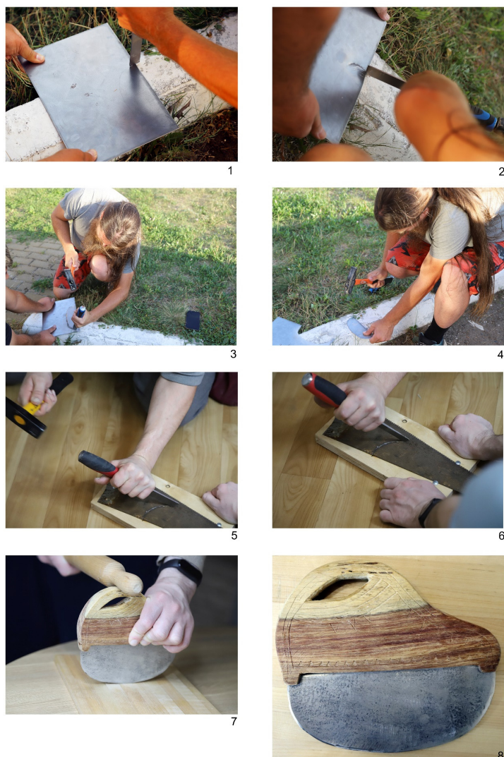
Рис. 6. Основные этапы изготовления реплики ножа-улу (улучик) из этнографической коллекции И.Г. Вознесенского эскимосов аляутиик с о. Кадыяк (МАЭ № 593-44): 1–4 — из незакаленной стали; 5–8 — из закаленной стали: 1 — начало выбивки ножа стамеской под 90° к обрабатываемой поверхности; 2, 3, 5, 6 — выбивка ножа стамеской под 30° к обрабатываемой поверхности; 4 — выравнивание полотна ножа молотком; 7 — насаживание рукояти на нож с помощью деревянной колотушки; 8 — реплика ножа-улу, полученная в ходе эксперимента.
